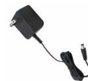
Model No.型号: WST-B12150U 12V.AC Transformer (USA plug) 12V.AC 交流变压器(美规) Input输入: 110V.AC Output输出: 12V AC Power功率: 12W
