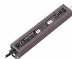
Model No.型号: WST-12024 Electronic transformer 直流电子变压器 Input输入: 110V-245V.AC Output输出: 12V DC Power功率: 24W
